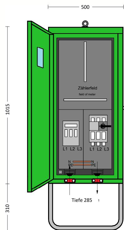
**ELEKTRA** - Anschlussschrank im Gehäuse aus verzinktem Stahlblech,
