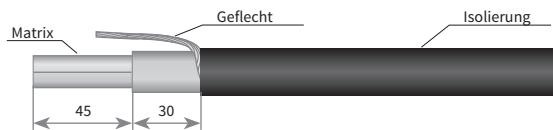
Entfernen Sie 45 mm der Matrix. Kürzen Sie einen der Versorgungsleiter auf 30 mm. Platzieren Sie den 1,5 mm Durchmesser Schrumpfschlauch über den Versorgungsleiter und schrumpfen Sie es. Schrumpftemperatur 200°C.
