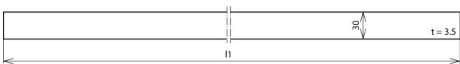
Aus korrosionsfestem Edelstahl NIRO (V4A), für den Anschluss der Ableitungen an die Erdungsanlage.
