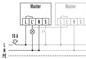
Standardbetrieb mit optionaler Ansteuerung durch Schließtaster und Parallelschaltung von max. 8 Geräten
