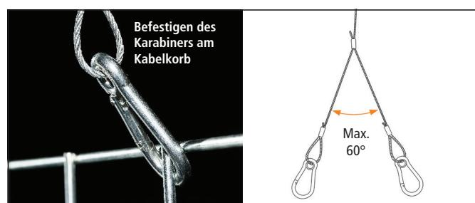
**Notiz:** Befestigen Sie Karabiner direkt gegenüber, um sicherzustellen die Vorrichtung waagerecht hängt und der Schnappverschluss immer vollständig geschlossen ist.
