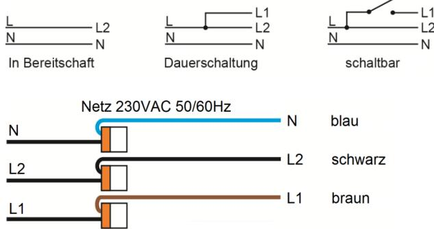
Nach dem Anschluss an das Netz wird der Ladevorgang gestartet und der Status der Leuchte durch die LED der Funktionsanzeige angezeigt. Nach ca. 20 Stunden ist der Ladevorgang abgeschlossen und die Leuchte ist betriebsbereit. Die Inbetriebnahme ist abgeschlossen, wenn durch einen ersten Brenndauerstest (an der Überwachungszentrale zu programmieren und zu starten) die geforderte Notbetriebsdauer von 3h bzw. 8h erreicht wird.
