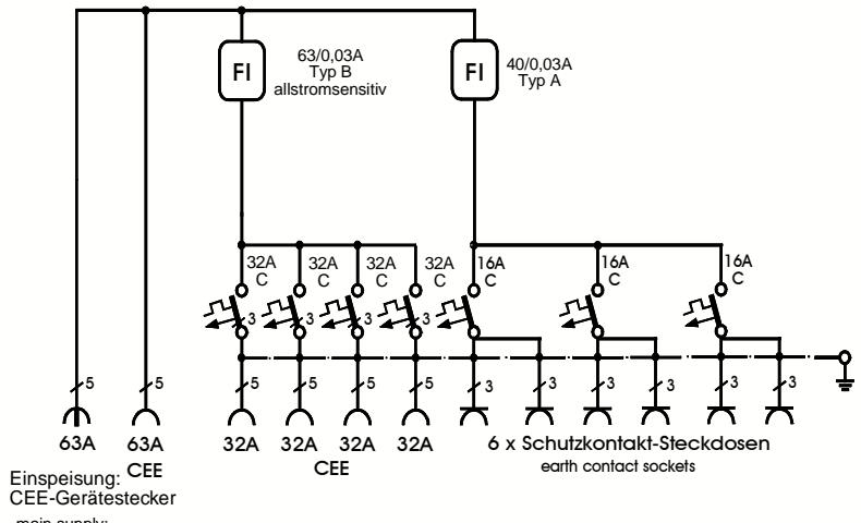
**ELEKTRA** - Endverteilerschrank im Gehäuse aus verzinktem Stahlblech,
