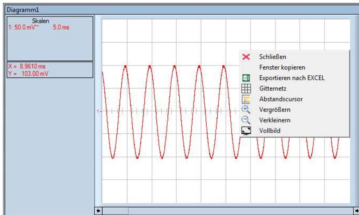
Wenn Sie mit der rechten Maustaste in ein Diagramm klicken, wird ein Kontextmenü angezeigt, das Zugriff auf die häufigsten Optionen ermöglicht.
