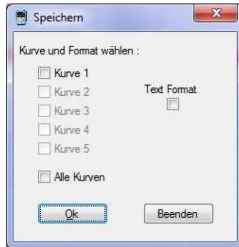
Mit diesem Befehl können Sie eine Kurve in einer Datendatei (\*.trc, \*.rec \*.txt und \*.per) oder ein komplettes Diagramm (\*.GRF) speichern.
