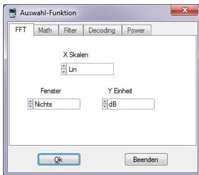
Die FFT wird anhand einer Punktzahl gleich einer Potenz von 2 ( $2^n$ ) berechnet.
