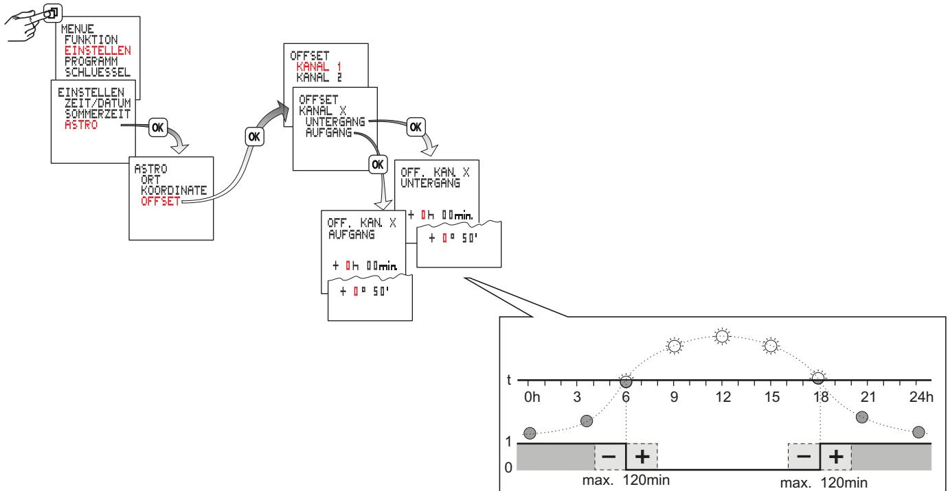
Die Uhr schaltet zu den errechneten Sonnenaufgangs- und Sonnenuntergangszeiten. Durch die Eingabe einer Differenzzeit wird der Schaltzeitpunkt um bis zu ±120 Minuten gegenüber den Sonnenauf- und Sonnenuntergangszeiten verschoben.
