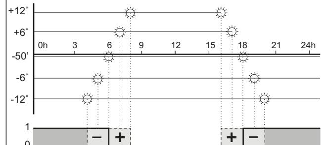
Bei Offset-Einstellung in Grad schaltet die Uhr trotz unterschiedlich langer Dämmerungszeiten im Jahresverlauf zu Zeitpunkten gleicher Helligkeit.
