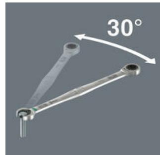
Durch die Doppelsechskant-Geometrie seines Maulendes wird der Rückholwinkel des Joker 6007 auf 30° reduziert. Der Joker 6007 hat ein gerades Maul, so dass er nicht mehr umständlich gewendet und neu angesetzt werden muss.
