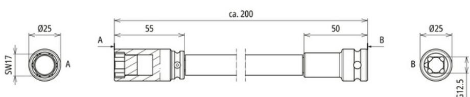
Edelstahl Verlängerungswerkzeug ca. 200 mm mit magnetisch gefederter Stecknuss (SW17) und einer 1/2 Zoll Vierkant Aufnahme für die Verwendung mit einem Schlagschrauber. Mit rotem Freilauf Griff. Zusätzlich enthalten: O-Ring und Sicherungsstift.
