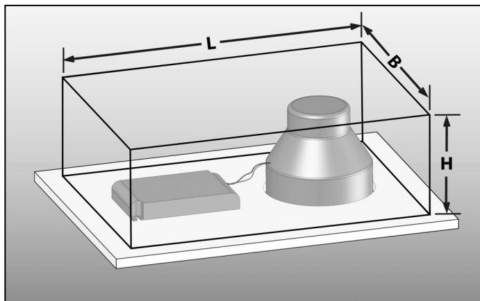
Mindestabstände von Leuchte und Versorgungseinheit im Einbaukasten ohne BRxx Etikett.
