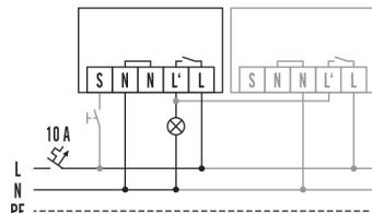
Standardbetrieb mit optionaler Ansteuerung durch Schließtaster und Parallelschaltung von max. 10 Geräten
