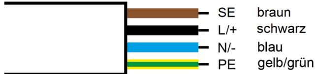
Der Flutlichtstrahler kann im DC-Betrieb in zwei Leistungsstufen DC-100% (volle Licht- und Verbrauchsleistung) und DC-Eco (reduzierte Licht- und Verbrauchsleistung) betrieben werden. Durch Brücken des SE-Steuereingangs an L /+ wird der DC-Eco aktiv geschaltet. Nach dem Umschalten von AC- auf DC-Spannungsversorgung (im Falle eines Tests oder im Notbetrieb) leuchtet Flutlichtstrahler mit reduzierter Lichtleistung.
