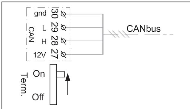
Bild 16 CAN-BUS-Terminierung
