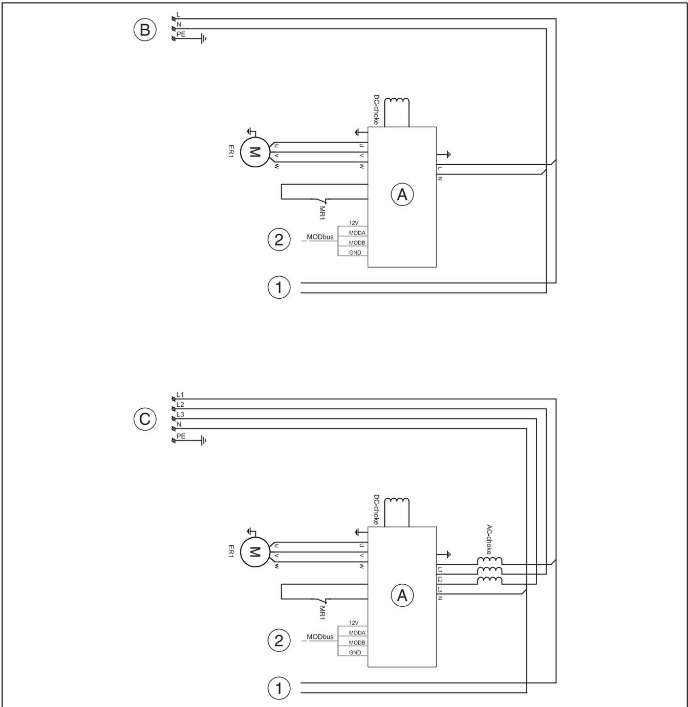
Bild 22 Schaltplan für Umformer, Wechselstrom / Drehstrom
