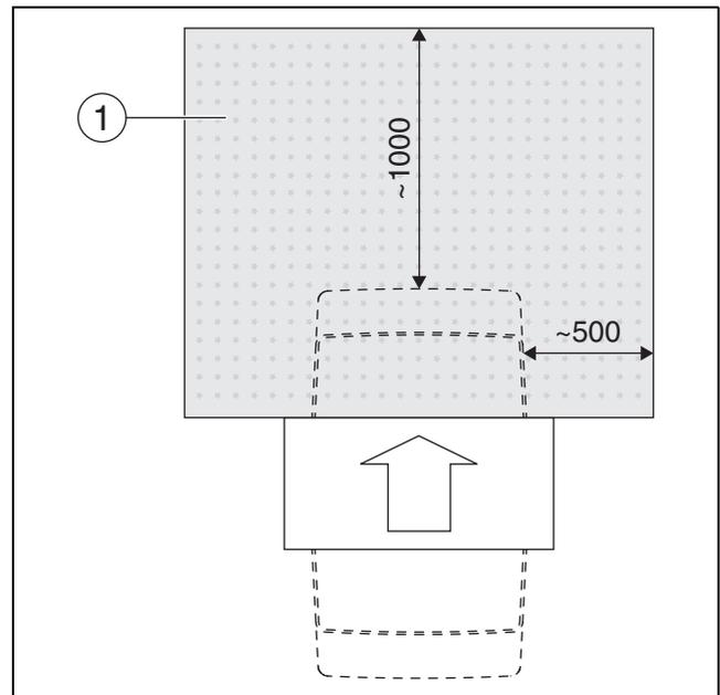
Bild 10 Gefahr! Eisbildung vor Wärmepumpen mit Lärmschutzvorrichtung (Zubehör)
