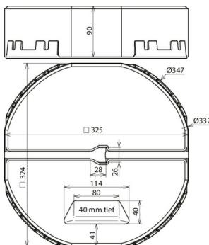
Betonsockel für Fangstangen, zum Schutz von kleineren Dachaufbauten auf Flachdächern und für das Errichten von Distanzhaltern z. B. für getrennte Ringleitungen oder freistehende Fangstangen im Dreibeinstativ.
