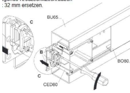
5. Der beiliegende Abdeckrahmen wird nur zum Kaschieren der Einbauöffnung bei Geräten, deren Flanschmaß 80 mm unterschreitet, eingesetzt. Die Montage der Dreisteckdose darf nur durch einen autorisierten Elektrofachmann erfolgen.
