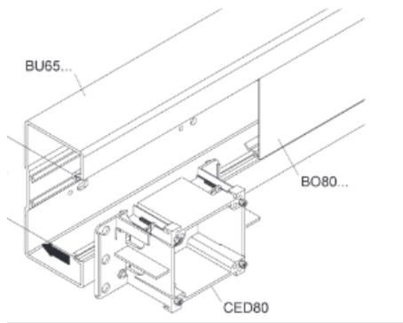
3. Die Industrie-Geräteneinbaudose CED80 mit den Befestigungsschrauben (A) festsetzen.
