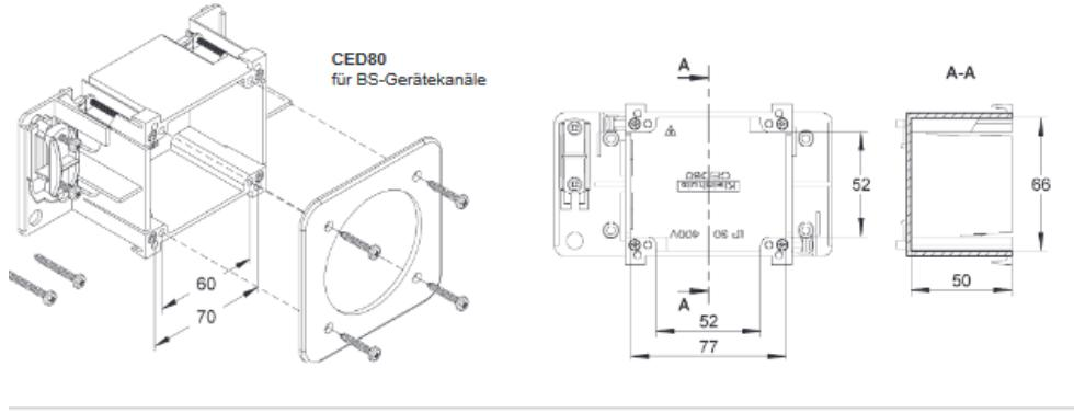
Die Industrie-Geräteneinbaudose CED80 in die Deckelrahmekontur des Gerätekanalunterteils einsetzen.
