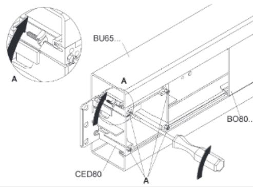
Die vormontierte Zugentlastung ggf. für einen anderen Kanalzug ummontieren (B). Bei Verwendung von ein mit großem Außendurchmesser Kreuzschlitzabutten 3,5 x 25 mm der Zugentlastung durch egende Kreuzschlitzschrauben : 32 mm ersetzen.
