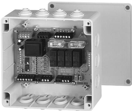
Das **Motorsteuergerät CD 2 x 1 P** ermöglicht die individuelle Ansteuerung von 2 x 230 V AC Antrieben. Da die Motorsteuergeräte lokal und zentral angesteuert werden können, eignet sich das CD 2 x 1 P für Klein- und Großobjektinstallationen. Zur Ansteuerung von zwei Antrieben ist nur ein Motorsteuergerät notwendig.
