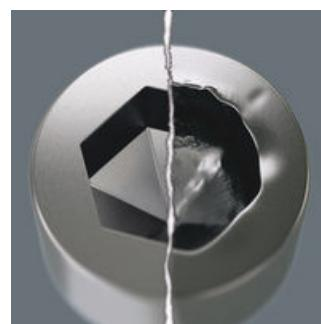
Innensechskantschrauben sind problematisch, denn die Anlageflächen, über die die Kraft vom Werkzeug auf die Schraube übertragen wird, sind sehr schmal. Die Folge: Der Schraubenkopf kann zerstört werden. Hex-Plus Werkzeuge haben größere Anlageflächen, die diese Gefahr verringern. Gut zu wissen: Hex-Plus Werkzeuge passen in jede Standard-Innensechskantschraube!
