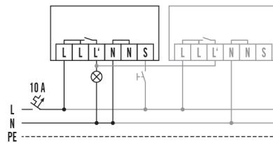
Standardbetrieb mit optionaler Ansteuerung durch Schließtaster und Parallelschaltung von max. 8 Geräten
