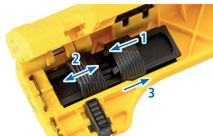
3. Kabel in die passende Kammer [1,5 mm<sup>2</sup>, 2,5 mm<sup>2</sup>, 4/6 oder 10/16 mm<sup>2</sup>] einlegen, Entmantler schließen, Werkzeug mit angemessenem Druck zusammendrücken, etwa 1/4 Umdrehung nach rechts und links drehen.
