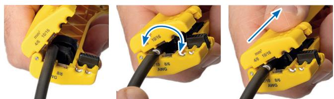
4. Entmantler öffnen, neu ansetzen, Kabel leicht abknicken und Mantel abstreifen. Fertig.
