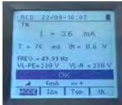
RCD Messung Typ B 6 mA mit Anzeige von Auslösestrom, Auslösezeit und Berührungsspannung (nur COMBI 521 & 519)
