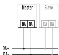
Master-Slave-Schaltung für Präsenzmelder: Es können max. 8 Slave-Geräte an ein Master-Gerät angeschlossen werden.
