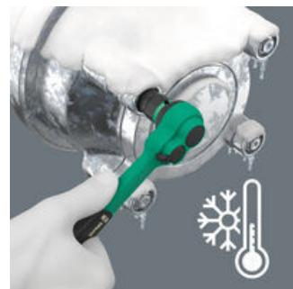
Die Zyklop Comfort Knarre ermöglicht durch ihre Feinverzahnung mit 80 Zähnen einen kurzen Rückholwinkel von nur 4,5°.
