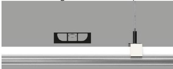
Maximaler Abstand zwischen den Montageclips (Kettenabhängiger)  $D = 2 \text{ m}$
