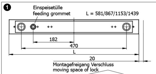
Bohrabstand für alle LUZ Leuchten gültig. Montage muss an den zwei dafür vorgesehenen Befestigungslöchern mit geeigneten Schrauben erfolgen.
