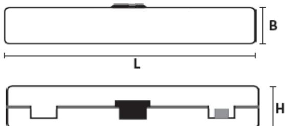
Abmessungen (LxBxH): 100 x 18 x 18 mm
