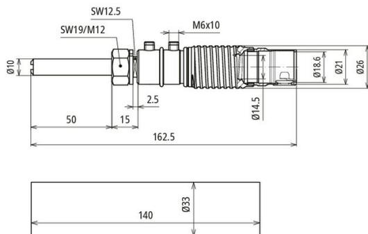
Ein isolierendes Anschlusselement zum Abschließen der HVI light plus Leitung erdseitig.
