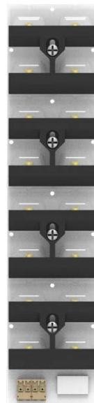
Nehmen Sie die mitgelieferten längeren Schrauben M3x12 und fixieren Sie damit die Linsenplatte und das Lichtschott. Achten Sie darauf, dass Sie die Ausrichtung der Linsen nicht verändern und das Lichtschott den hinteren Teil der Linsenplatte abdeckt, der zur Klemme der Platine gerichtet ist.
