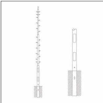
Mast, konisch rund, aus Stahl, verzinkt, Typ 1: Aufsatz, Durchmesser: 108 mm, Höhe: 16m, Zopfmaß: 108mm, Verpackungseinheit: 1 Stück
