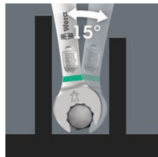
Der Ringmaulschlüssel Joker 6003 mit seiner besonderen Maulgeometrie - eine um 7,5° geschwenkte Maulseite und die Doppelsechskantgeometrie - verdoppelt die Ansetzmöglichkeiten bei wiederholter 180°-Drehung des Schlüssels um die Längsachse. Muttern bzw. Schraubenköpfe können alle 15° "gepackt" werden. Den jeweiligen Ansetzpunkt findet der Joker 6003 nach jedem Wenden sozusagen von selbst.
