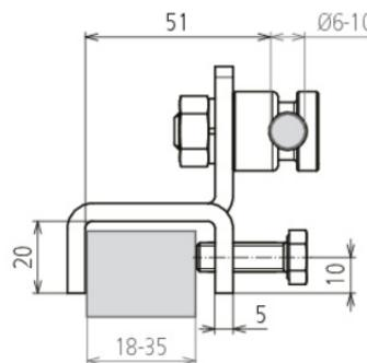
Schwere Ausführung; für den Anschluss an Stahlkonstruktionen.
