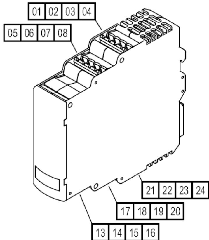
**Auswerteeinheit zur Drehzahlüberwachung**
