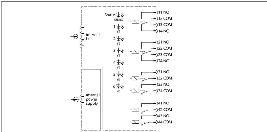
Das Relaismodul DO60R-N dient zum Anschluss von nicht eigensicheren Aktuatoren wie Ventilen oder Anzeigeelementen.
