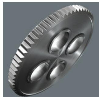
Feinzelzahnmechanik mit 60 Zähnen ermöglicht einen kleinen Rückholwinkel von 6° für präzises Arbeiten.
