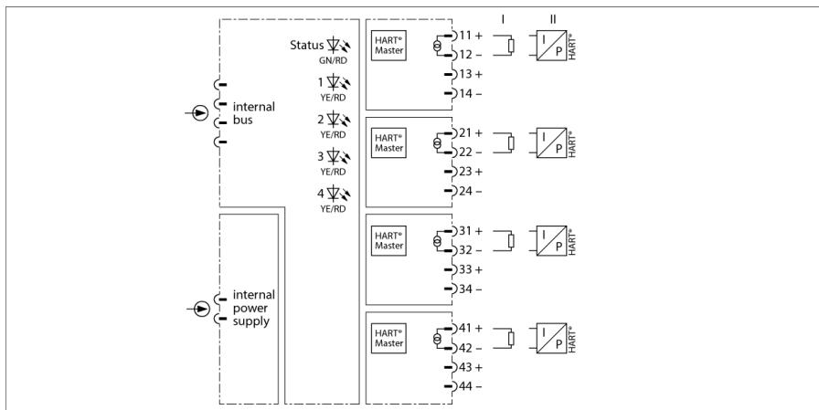
Das Ausgangsmodul AOH401Ex dient zum Anschluss von analogen Aktuatoren wie Stellventilen oder Prozessanzeigen.
