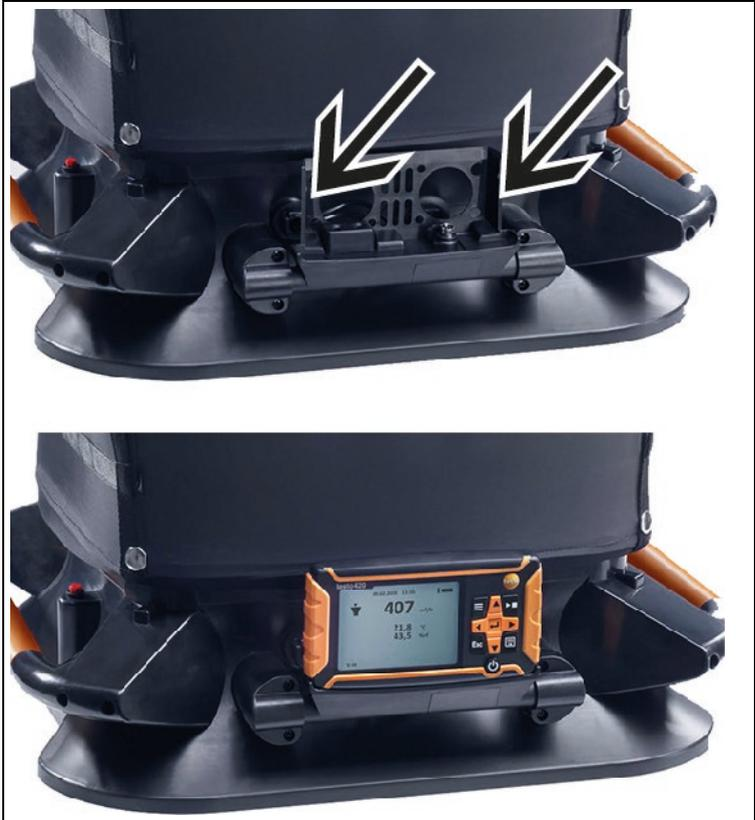
1. Schieben Sie das testo 420 komplett in die Geräte-Aufnahme, achten Sie hierbei auf die Arretierung rechts und links in der Halterung.
