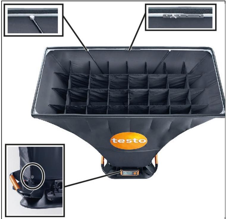
1. Montieren Sie den Alurahmen und spannen die Stoffhaube über den Rahmen, so dass das Gummiband in der Aussparung des Rahmens verläuft. Achten Sie dabei auf den korrekten Sitz des Gummibandes, vor allem an den Ecken.
