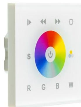
DMX-Wandpanel für die Ansteuerung der DMX-Controller. Für Schalterdosensmontage geeignet. Funktionen: Farbwechsel über Touch-Farbrad, Direktfarbwahl (rot, grün, blau und weiß), Ein- und ausschalten, so wie Programmwechsel. Passend für DMX-C4x5A, DMX-C350MA und DMX-C700MA.
