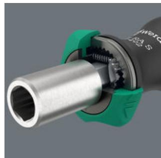
Die integrierte Ratsche mit Feinverzahnung sorgt für schnelles und sicheres Arbeiten. Die Knarrenmechanik ist vollständig im Griff eingebettet. Die kleine Größe des Griffes ermöglicht den Einsatz der Ratsche auch in beengten Schraubsituationen.
