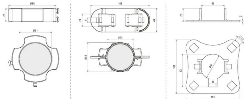
Befestigungsset zur Montage der HVI light plus Leitung an HVI Stützrohren Ø50 mm, bestehend aus Anschlussplatte und Befestigungsring mit NIRO-Spannschelle für den Endverschluss (inkl. vier Kunststoffhalterhalbteile und zwei Kabelbindern).
