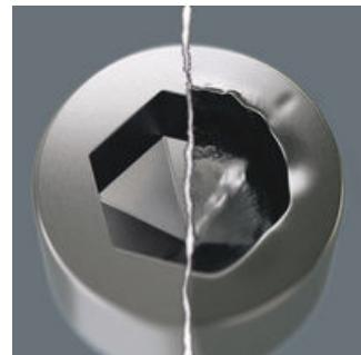
Innensechskantschrauben sind problematisch, denn die Anlageflächen, über die die Kraft vom Werkzeug auf die Schraube übertragen wird, sind sehr schmal. Die Folge: Der Schraubenzapfen kann zerstört werden. Hex-Plus Werkzeuge haben größere Anlageflächen, die diese Gefahr verringern. Gut zu wissen: Hex-Plus Werkzeuge passen in jede Standard-Innensechskantschraube!
