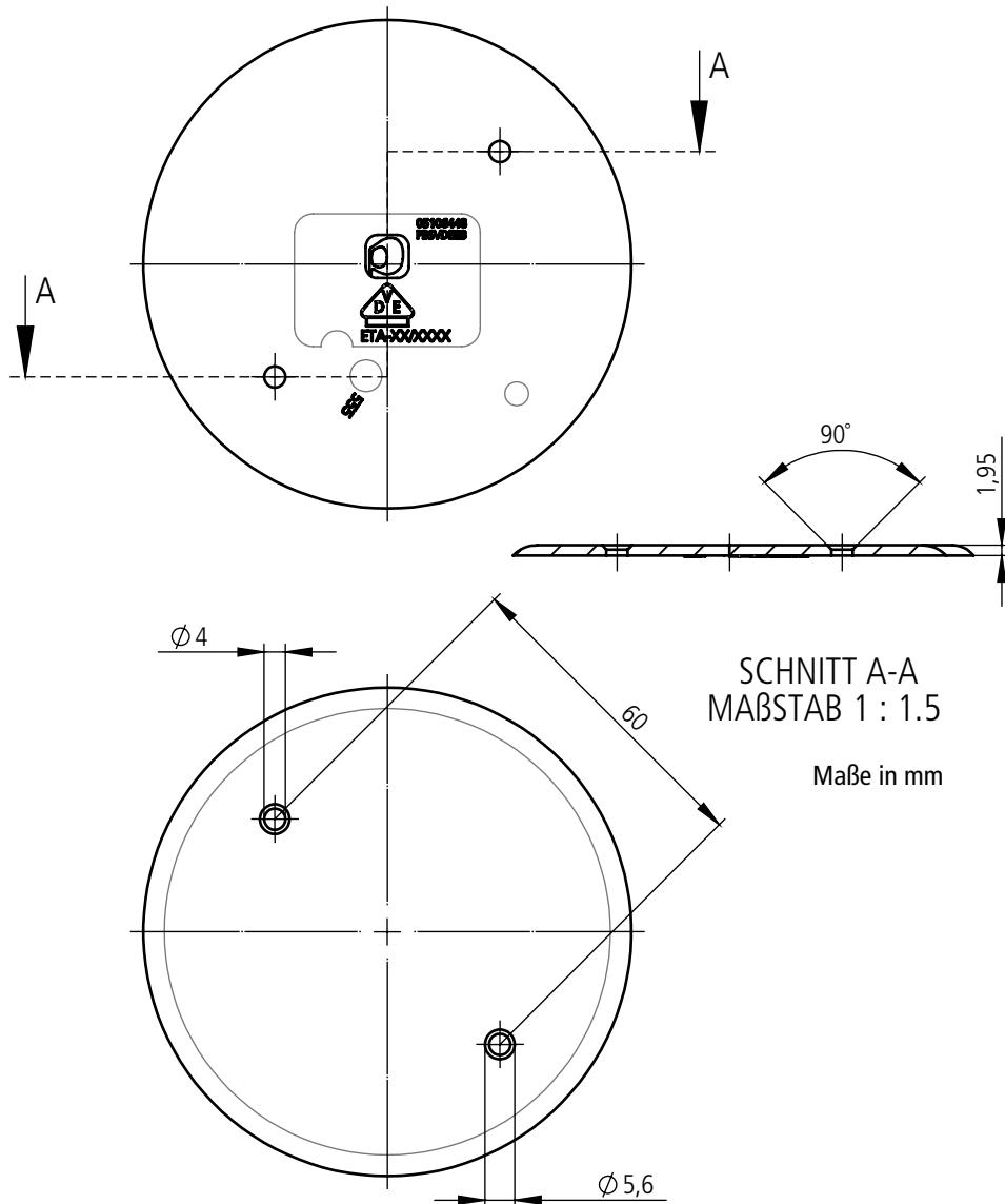
Bauart zum Verschließen von Elektroinstallationsöffnungen
