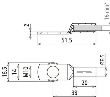
Presskabelschuh nach DIN 46235 mit Nickelsperrschiicht zur Vermeidung von Whiskerbildung.
