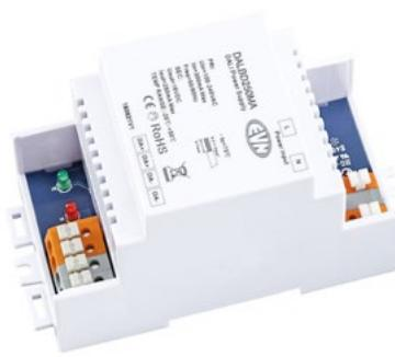
Die DALI-Basisstation verfügt über 2 BUS-Ausgänge und einen max. Ausgangstrom von 250mA, wodurch auch größere Leitungswände ohne Probleme realisiert werden können. Natürlich ist die Basisstation kompatibel zu allen gängigen DALI-Komponenten. Die Klemmen, sowohl Primär- als auch sekundärseitig, sind für Kabel von 0,5mm<sup>2</sup> - 1,5mm<sup>2</sup> geeignet. Technische Daten: ta: -20°C - 50°C, tc: 75°C. Konform Standardprotokoll IEC 60929.
