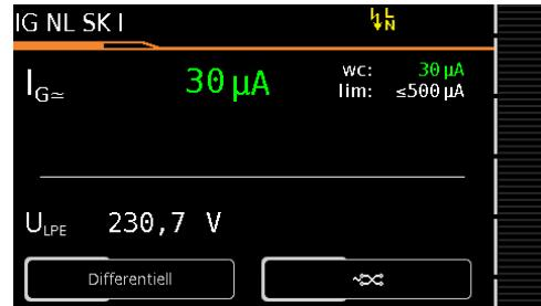
Prüfsequenz – Prüfergebnis (IEC 62353)
