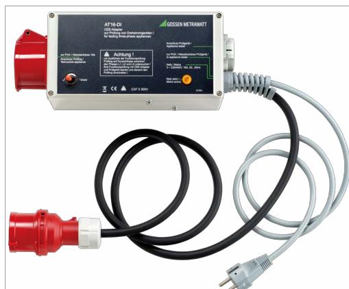
AT16-DI an Geräten mit CEE-Steckern durchgeführt werden:
