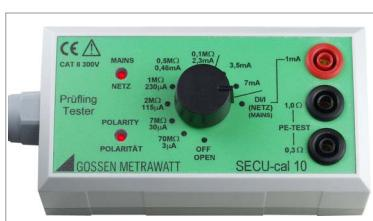
Es sind dabei alle Grenzwerte für die geforderten Prüfungen nach DIN VDE wie Schutzleiterwiderstand, Isolationswiderstand, Ersatzableitstrom, Differenz- und/oder Berühr- bzw. Gehäuseableitstrom zu überprüfen.
