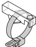
■ Montage auf Rundzylinder mit Zusatzhalterung
