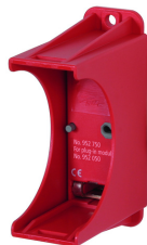
Einpoliger Sockel zur Montage auf Geräteleiterplatten für DEHNgard Module, mit Fernmeldekontakt für Überwachungseinrichtung (potentialfreier Wechsler).
