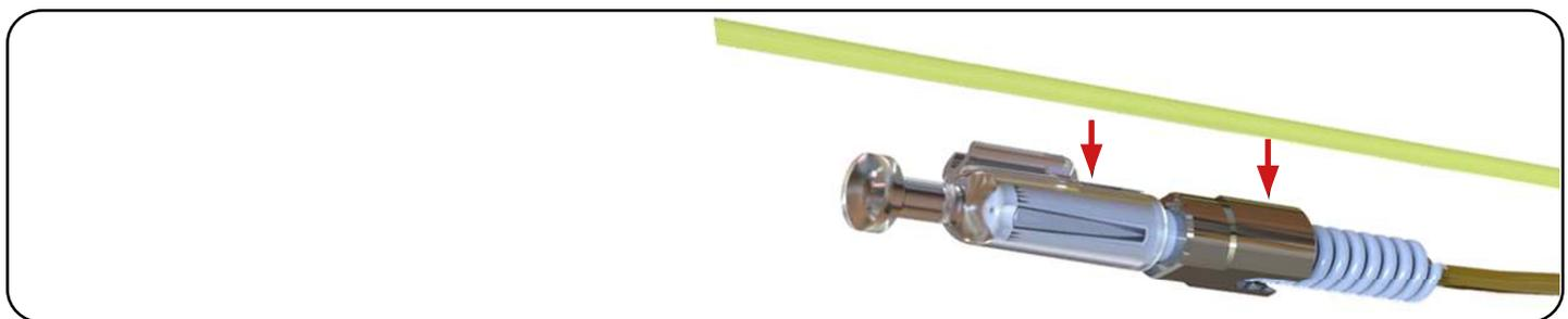
Schritt 3: Klemmen Sie alle 4 Staubschutzkappen vom Zugelement ab ohne die Glasfasern zu knicken
