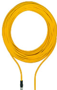
Anschlusskabel, PUR, Gelb RAL1003, Schleppkettenfähig, 8-polig, Stecker gerade M12, auf offenes Leitungsende, A-kodiert, Kabellänge: 2 m
