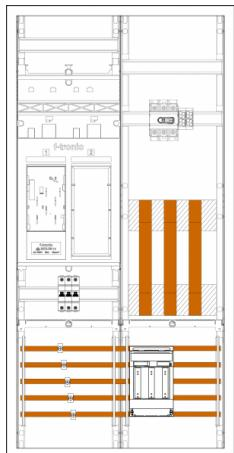
**Wandlerschrank eHZ 100A, EHZ721W100LS, NH-Trenner 160A, LS-Schalter B6A 3-polig 25kA**
